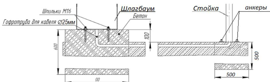
Перед заливкой бетона внутри отводов кабельных каналов следует проложить проволоку для протяжки электрических кабелей и защитить внутренние полости кабельных каналов от попадания бетона.
