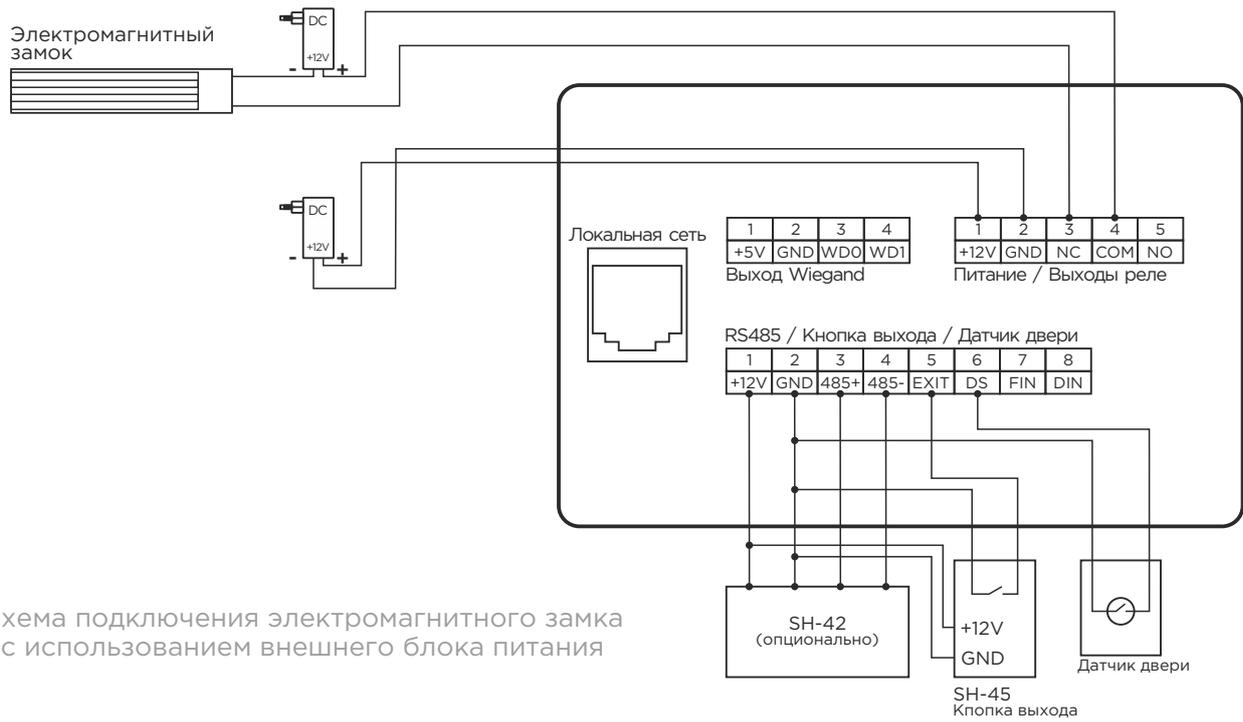
Схема подключения электромагнитного замка с использованием внешнего блока питания
