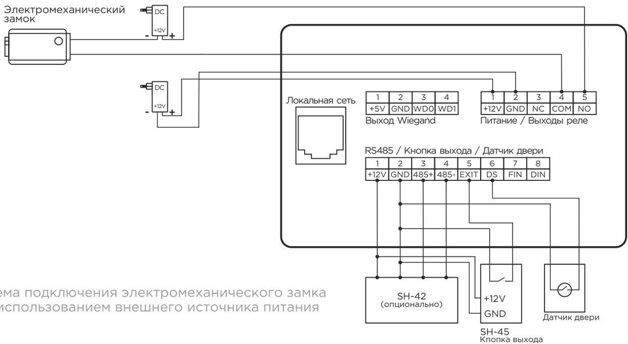
Схема подключения электромеханического замка с использованием внешнего источника питания
